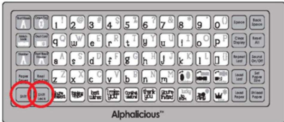
Benutzen Sie die **Shift Lock** (Umschaltsperre) Taste, um mehr als einen Buchstaben gleichzeitig aus der rechten Oberecke zu wählen. Betätigen Sie die **Shift Lock** (Umschaltsperre) Taste wieder, um sie abzuschalten.
