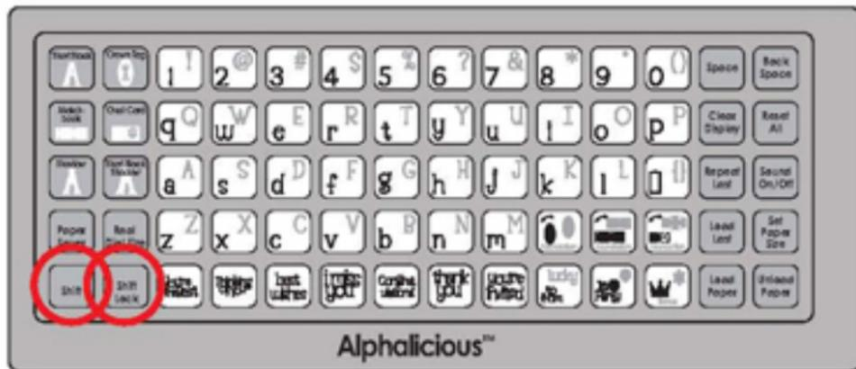
Use la tecla **Shift Lock** (Fijación) para seleccionar simultáneamente más de un carácter del extremo superior derecho de las teclas. Presione nuevamente la tecla **Shift Lock** (Fijación) para desactivarla.
