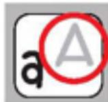
Para seleccionar un carácter del extremo superior derecho de una tecla, use la tecla **Shift** (Alternar) del teclado. No necesita mantenerla presionada. Simplemente presione la tecla **Shift** (Alternar) una vez y haga su selección.
