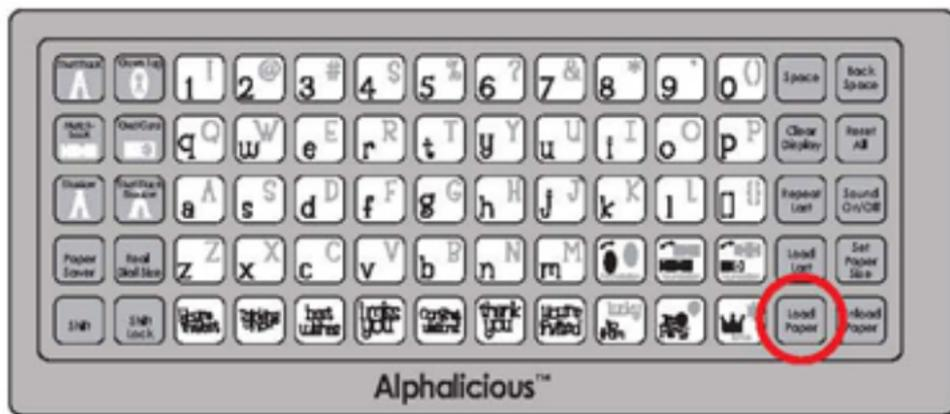
DATO PRACTICO: Su máquina requiere 12" (30.48 cm) de espacio disponible en la parte delantera y posterior para permitir el movimiento del papel hacia y desde su máquina Cricut™. Si el papel no se carga correctamente, presione la tecla **Unload Paper** (Descarga de Papel) e inténtelo nuevamente.
