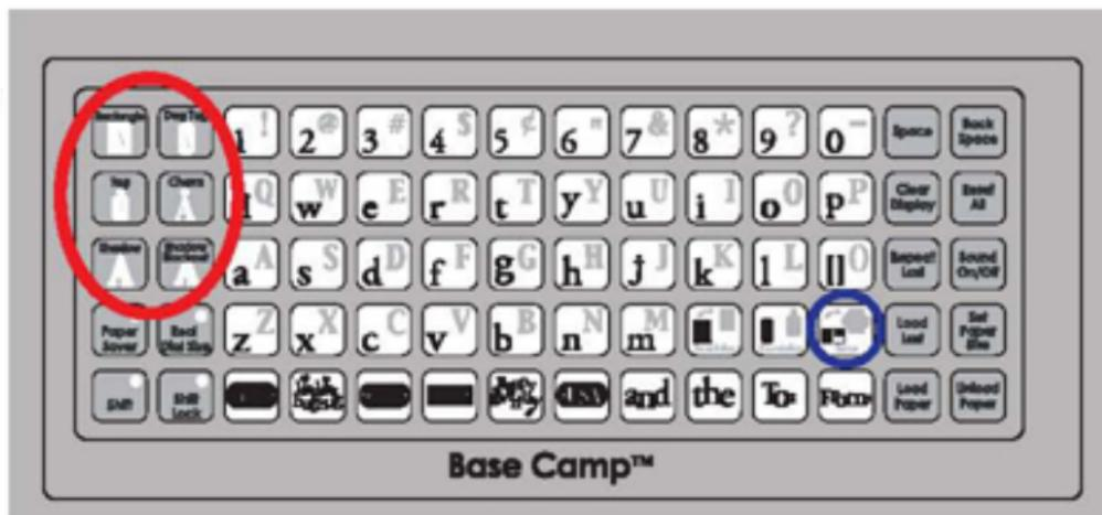
DATO PRACTICO: No puede mezclar Funciones en un corte. La función que haya seleccionado cuando presione el botón de CUT (Corte) determinará el aspecto de todas las letras, formas, o frases en la pantalla LCD.
