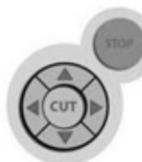
El botón de **STOP** (Detención) ubicado al lado del botón de **CUT** (Corte) detendrá cualquier operación en curso. Los **Blade Navigation Buttons** (Botones de Navegación de la Cuchilla) desplazan la cuchilla hacia cualquier posición en el papel.
