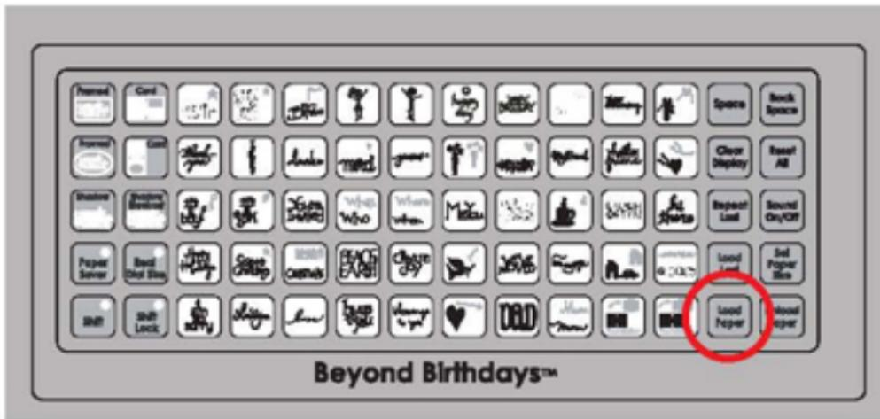
TIPP: Ihre Cricut™-Maschine braucht einen freien Raum von 12 Zoll vorne und hinten für die Bewegung des Papiers in und aus der Cricut™-Maschine. Falls Ihr Papier nicht geladen wird, betätigen Sie die **Unload Paper** (Papier ausladen) Taste und wiederholen Sie den Versuch.
