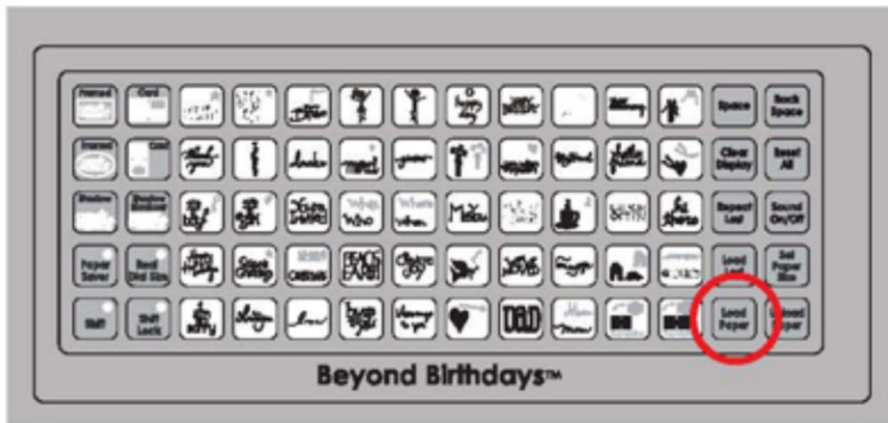
DATO PRACTICO: Su máquina requiere 12 pulgadas (30.5 cm.) de espacio disponible en la parte delantera y posterior para permitir el movimiento del papel hacia y desde su máquina Cricut™. Si el papel no se carga correctamente, presione la tecla **Unload Paper** (Descarga de Papel) e inténtelo nuevamente.
