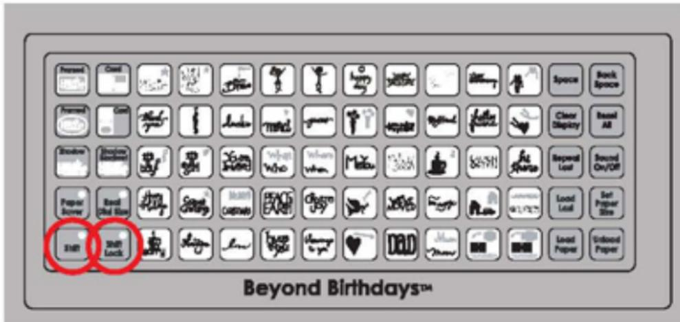
Use la tecla Shift Lock (Fijación) para seleccionar simultáneamente más de una forma o frase del extremo superior derecho de las teclas. Presione nuevamente la tecla Shift Lock (Fijación) para desactivarla. Si un carácter ocupa toda la tecla se exhibirá ya sea que la tecla Shift (Alternar) esté seleccionada o no.
