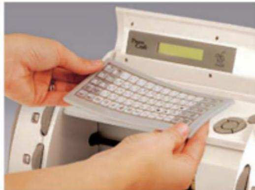
1. Branchez votre machine Cricut™ sur une prise et allumez-la. Mettez le panneau de superposition du clavier sur le clavier de la machine Cricut™.
