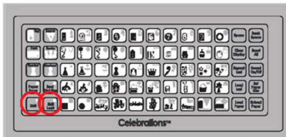
Benutzen Sie die Shift Lock (Umschaltsperrre) Taste, um mehr als eine Figur oder Phrase gleichzeitig aus der rechten Oberseite zu wählen. Betätigen Sie die Shift Lock (Umschaltsperrre) Taste wieder, um sie abzuschalten.
