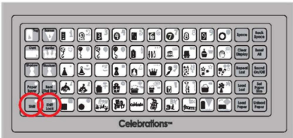
Utilisez la touche Shift Lock (Touche de Verrouillage) pour sélectionner simultanément plus d'une forme ou phrase des extrémités supérieures droites des touches. Pressez la touche Shift Lock (Touche de Verrouillage) à nouveau pour la désactiver.
