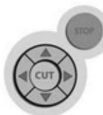
El botón de **STOP** (Detención) ubicado al lado del botón de **CUT** (Corte) detendrá cualquier operación en curso. Los **Blade Navigation Buttons** (Botones de Navegación de la Cuchilla) desplazan la cuchilla hacia cualquier posición en el papel.
