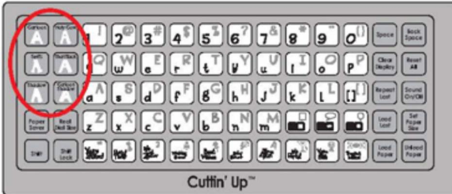
**DATO PRACTICO:** Se puede seleccionar una tecla de Función antes o después de haber seleccionado una caráctere, pero debe realizarse antes de presionar el botón de **CUT** (Corte). Una vez que se ha presionado una tecla de Función, ésta permanecerá iluminada hasta desactivarla de una de las siguientes maneras: se presiona por segunda vez la tecla de Función o se presiona la tecla **Reset All** (Restablecer Todo).
