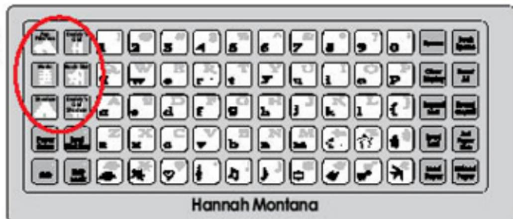
**DATO PRACTICO:** Se puede seleccionar una tecla de Función antes o después de haber seleccionado una carácter, pero debe realizarse antes de presionar el botón de **CUT** (Corte). Una vez que se ha presionado una tecla de Función, ésta permanecerá iluminada hasta desactivarla de una de las siguientes maneras: se presiona por segunda vez la tecla de Función; o se presiona la tecla **Reset All** (Restablecer Todo).
