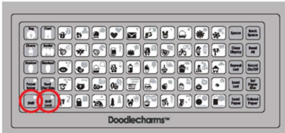
Utilisez la touche Shift Lock (Touche de Verrouillage) pour sélectionner simultanément plus d'une forme des extrémités supérieures droites des touches. Pressez la touche Shift Lock (Touche de Verrouillage) à nouveau pour la désactiver.
