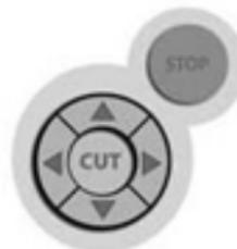
El botón de **STOP** (Detención) ubicado al lado del botón de **CUT** (Corte) detendrá cualquier operación en curso. Los **Blade Navigation Buttons** (Botones de Navegación de la Cuchilla) desplazan la cuchilla hacia cualquier posición en el papel.
