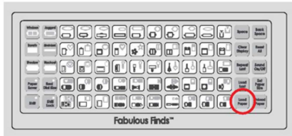
TIPP: Ihre Cricut™-Maschine braucht einen freien Raum von 12 Zoll (30.48 cm) vorne und hinten für die Bewegung des Papiers in und aus der Cricut™-Maschine. Falls Ihr Papier nicht geladen wird, betätigen Sie die **Unload Paper** (Papier ausladen) Taste und wiederholen Sie den Versuch.
