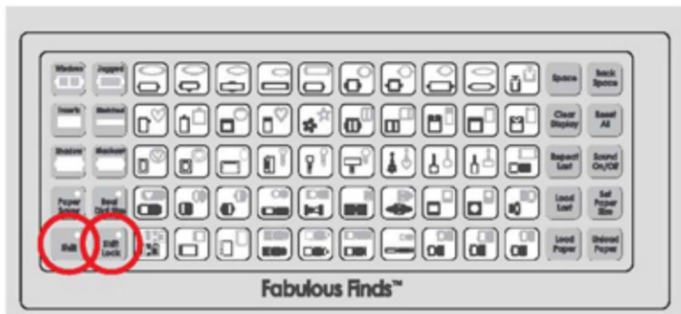
Utilisez la touche Shift Lock (Touche de Verrouillage) pour sélectionner simultanément plus d'une caractères des extrémités supérieures droites des touches. Pressez la touche Shift Lock (Touche de Verrouillage) à nouveau pour la désactiver.
