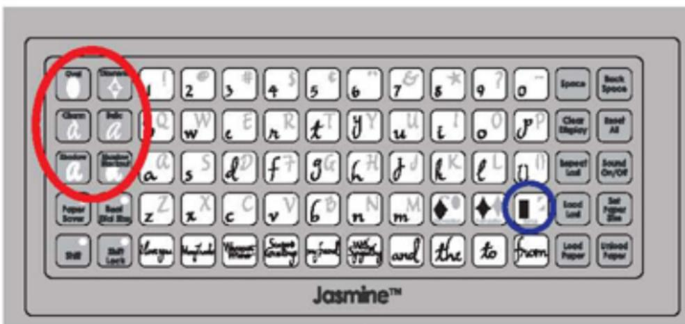
**CONSEJO:** No se pueden mezclar funciones dentro de un corte. Cualquiera sea la función seleccionada, cuando se presiona el botón de corte se determina el tamaño de todas las letras/formas/frases de dicho corte.
