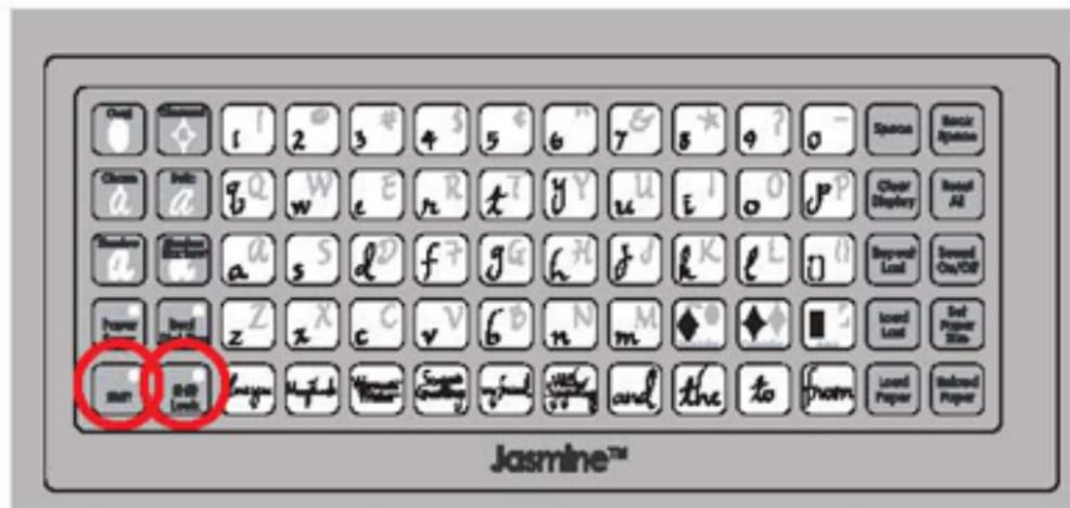
Benutzen Sie die Shift Lock (Umschaltsperrre) Taste, um mehr als einen Buchstaben, eine Figur oder Phrase gleichzeitig aus der rechten Oberecke zu wählen. Betätigen Sie die Shift Lock (Umschaltsperrre) Taste wieder, um sie abzuschalten.
