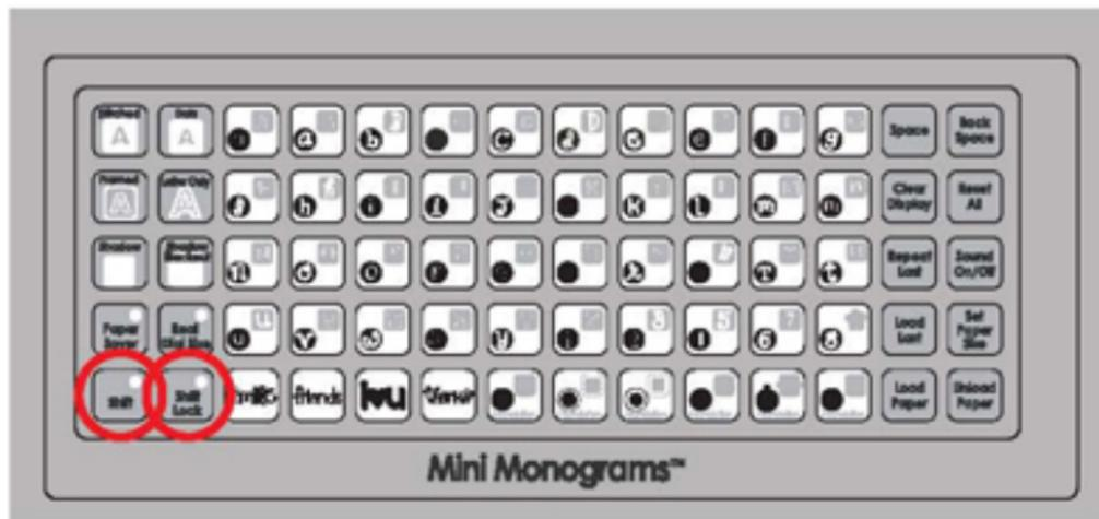
Utilisez la touche **Shift Lock** (Touche de Verrouillage) pour sélectionner simultanément plus d'une lettre, forme, ou phrase des extrémités supérieures droites des touches. Pressez la touche **Shift Lock** (Touche de Verrouillage) à nouveau pour la désactiver.
