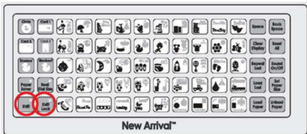
Utilisez la touche **Shift Lock** (Touche de Verrouillage) pour sélectionner simultanément plus d'une caractères des extrémités supérieures droites des touches. Pressez la touche **Shift Lock** (Touche de Verrouillage) à nouveau pour la désactiver.
