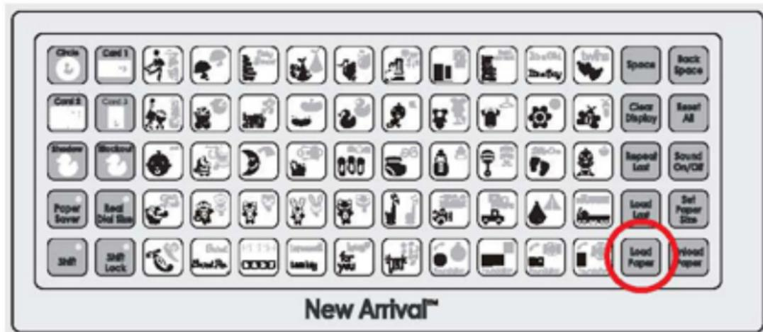
TIPP: Ihre Cricut<sup>™</sup>-Maschine braucht einen freien Raum von 12 Zoll vorne und hinten für die Bewegung des Papiers in und aus der Cricut<sup>™</sup>-Maschine. Falls Ihr Papier nicht geladen wird, betätigen Sie die **Unload Paper** (Papier ausladen) Taste und wiederholen Sie den Versuch.
