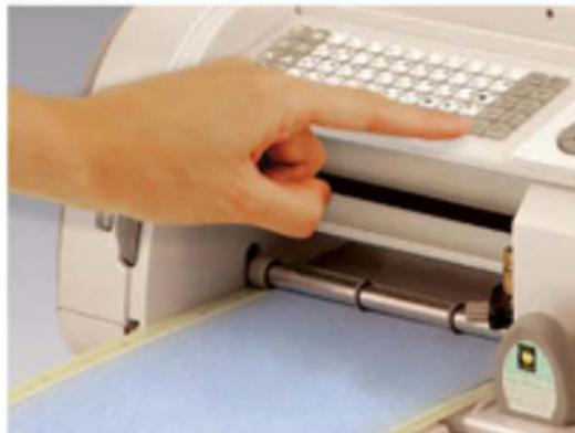
4. Betätigen Sie die **Load Paper** (Papier laden) Taste. Das Papier wird in die Cricut<sup>™</sup>-Maschine eingeschoben.
