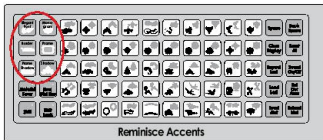
DATO PRACTICO: Se puede seleccionar una tecla de Función antes o después de haber seleccionado un carácter, pero debe realizarse antes de presionar el botón de CUT (Corte). Una vez que se ha presionado una tecla de Función, ésta permanecerá iluminada hasta desactivarla de una de las siguientes maneras: se presiona por segunda vez la tecla de Función o se presiona la tecla Reset All (Restablecer Todo).
